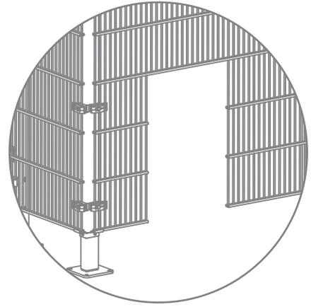
Durch die Größe und die Position der Öffnungen darf die Stabilität des Gitterelements nicht beeinträchtigt werden.
